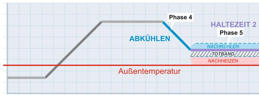
Liegt die Außentemperatur unter der Abkühltemperatur, muss in bestimmten Fällen zum Halten der eingestellten Solltemperatur in Haltezeit 2 nicht gekühlt sondern aufgeheizt werden, da ansonsten die Temperatur zu weit abfällt.
