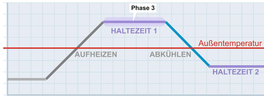
Während der Haltezeit 1 (Phase 3) hält der Regler die eingestellte Solltemperatur konstant. Der Regler heizt bei Bedarf nach
