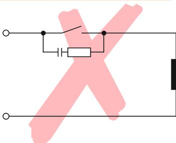
Der nebenstehend abgebildete Einbau des RC-Filters direkt am Schaltkontakt des Reglers sollte unterbleiben, da selbst bei geöffnetem Schaltkontakt ein Blindstrom über die RC-Kombination fließt. Dieser Strom kann ausreichen, um ein nachgeschaltetes Schütz nicht abfallen zu lassen, so dass ein geschlossener Schützkontakt gar nicht mehr öffnet.
