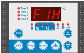
*Ein auftretender Fehler wird auf dem Display als Fehlercode blinkend angezeigt.*
