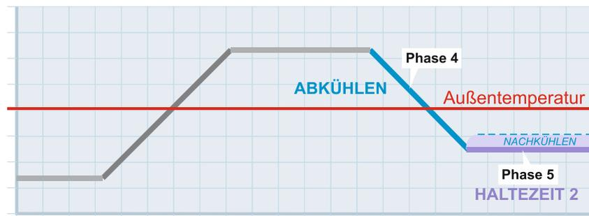
Nach dem Abkühlen hält der Regler in der Haltezeit 2 (Phase 5) die eingestellte Solltemperatur konstant. Liegt die Außentemperatur über der Abkühltemperatur, kühlt der Regler bei Bedarf nach (falls die Temperatur wieder ansteigt).
