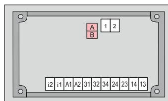
Der Regler verfügt über eine RS485-Schnittstelle als Anschlussmöglichkeit für einen PC mit der Welba-Konsoft (siehe Abschnitt 5.2) zum Parametrieren, Updaten und Auslesen der Daten.
