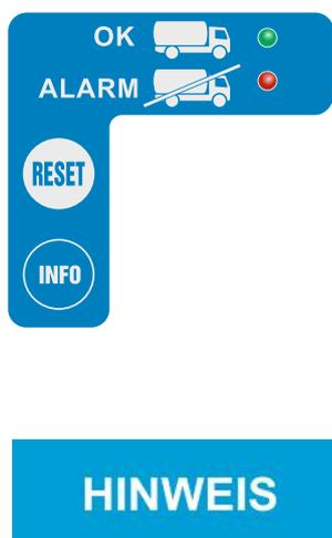
Leuchtet die rote LED für einen der Tanks permanent bedeutet dies, dass kritische Fehler bereits quitiert wurden, aber immer noch anliegen. Diese Fehlercodes sind im geräteinternen Fehlerspeicher hinterlegt und können wie folgt ausgelesen werden:
