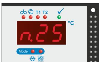
Während des Reinigungsablaufs wird im Display je nach Einstellung in Parameter [r97] der momentan ausgeführte Programmschritt oder die aktuelle Temperatur angezeigt.
