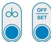
Im OFF-Modus lässt sich das Rührwerk mit der Taste "Rührer" ein- und mit der Taste "OFF" wieder ausschalten.
