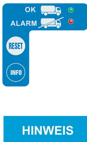
Leuchtet die rote LED für einen der Tanks permanent bedeutet dies, dass kritische Fehler bereits quittiert wurden, aber immer noch anliegen. Diese Fehlercodes sind im geräteinternen Fehlerspeicher hinterlegt und können wie folgt ausgelesen werden:
