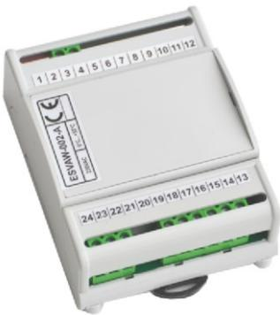
Rührer-Überwachungsmodule ermitteln unabhängig für jeden angeschlossenen Motor die aufgenommene Leistung. Hieraus wird abgeleitet, ob sich der jeweilige Motor dreht und ob er ohne oder mit Belastung läuft. So kann z.B. ein defekter Rührerflügel erkannt werden.
