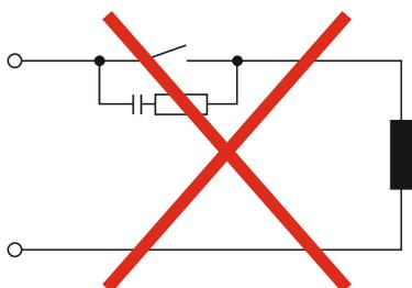
Der nebenstehend abgebildete Einbau des RC-Filters direkt am Schaltkontakt des Reglers sollte unterbleiben, da selbst bei geöffnetem Schaltkontakt ein Blindstrom über die RC-Kombination fließt. Dieser Strom kann ausreichen, um ein nachgeschaltetes Schütz nicht abfallen zu lassen, so dass ein geschlossener Schützkontakt gar nicht mehr öffnet.
