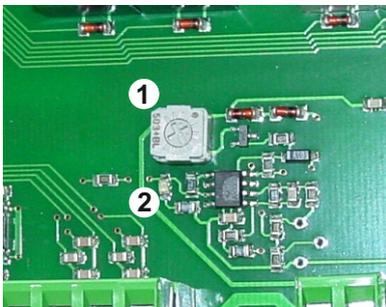
Die Niveausteuering ist werkseitig auf 'mittlere' Wasserqualität voreingestellt. Je nach Härtegrad im örtlichen Wassernetz kann die Empfindlichkeit über ein Potentiometer wie folgt verstellt werden:
