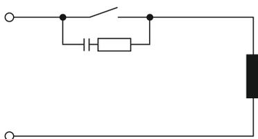
Der nebenstehend abgebildete Einbau des RC-Filters direkt am Schaltkontakt des Reglers sollte unterbleiben, da selbst bei geöffnetem Schaltkontakt ein Blindstrom über die RC-Kombination fließt. Dieser Strom kann ausreichen, um ein nachgeschaltetes Schütz nicht abfallen zu lassen, so dass ein geschlossener Schützkontakt gar nicht mehr öffnet.
