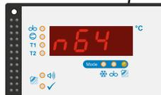
Während des Reinigungsablaufs wird im Display der momentane ausgeführte Programmschritt angezeigt (Werkseinstellung). Der blinkende Punkt signalisiert Aktivität.
