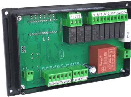
Die WTS-200 ist universell für alle Anlagentypen einsetzbar. Relais und digitale Eingänge sind bereits werkseitig vorparametriert.
