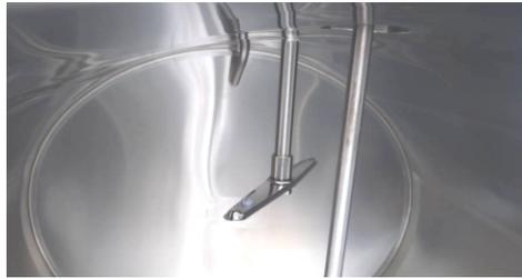
Die Reinigung des Milchkühltanks erfolgt nach vor-eingestelltem Ablaufschema, das auf die örtlichen Gegebenheiten angepasst werden kann. Sie kann wahlweise mit ein- oder zwei Hauptspülgängen ausgeführt werden.
