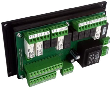
Die WTS-100 ist universell für alle Anlagentypen einsetzbar. Relais und digitale Eingänge sind bereits werkseitig vorparametriert.
