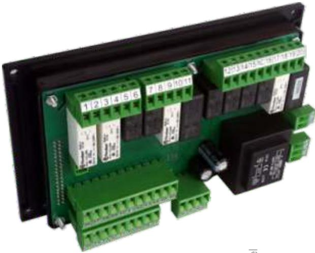
Die WTS-300 ist universell für alle Anlagentypen einsetzbar. Relais und digitale Eingänge lassen sich frei für vielfältige Funktionen parametrieren.
